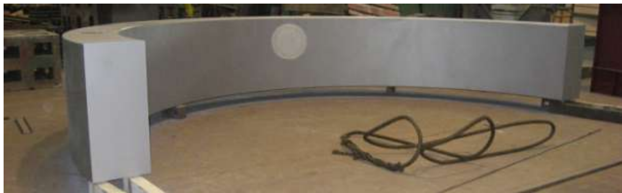
Бандаж опорный \text{Ø}6750 мм на вращающуюся печь
